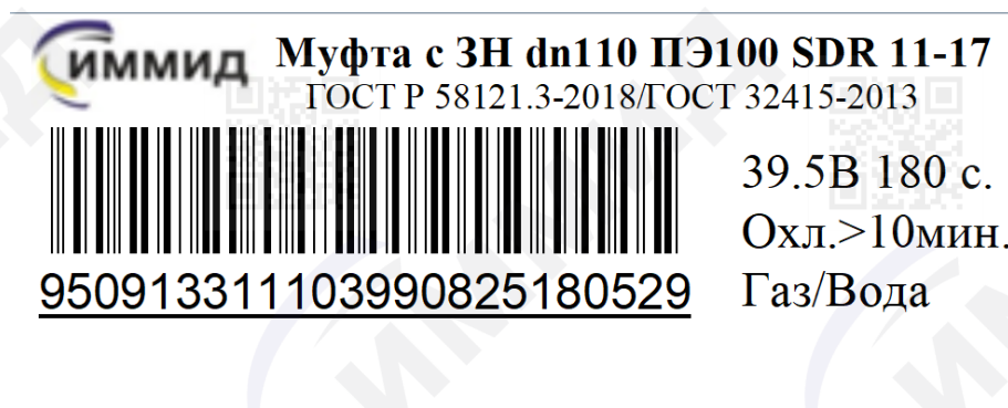
Этикетка содержит параметры сварки и штрихкод по ГОСТ Р ИСО 13950.
